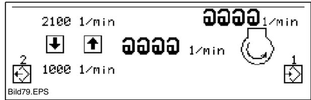
Um den Sollwert der Motordrehzahl einzustellen, Taste (A) drücken (Zahl wird schwarz unterlegt und blinkt), mit den Tasten (D/E) gewünschten Wert einstellen. Zur Übernahme der Änderung Taste (F) drücken und mit Taste (A) bestätigen. Menüunterpunkt durch erneutes drücken der Taste (26) verlassen.
